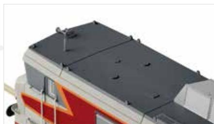
Réalisation correcte du côté du toit sans pantographe
