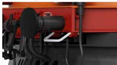
Traverse porte-tampon avec poignées dégagées et câble du chauffage
