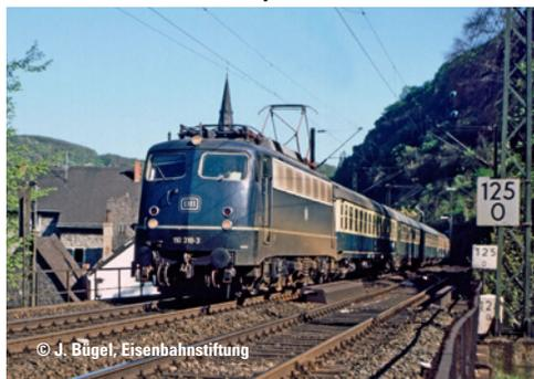
**Modèle réel :** Locomotive électrique unifiée 110 318-3 de la Deutsche Bundesbahn (DB). Surnommée « Bügelfalte » (pli marqué au repassage). Livrée de base bleu cobalt. Version avec doubles lampes, gouttières en plastique au-dessus des fenêtres frontales et portes sur le poste de conduite, bande d'aération « continue » composée de 7 « grilles d'aération Klatte longues » et poignées frontales. Sans tablier et sans carénage de tampon Etat vers 1983.
