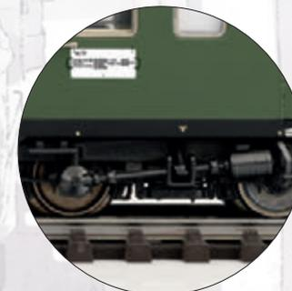
Conformément au modèle réel avec bogies Minden-Deutz (MD) lourds type 330 et générateur à cardan type D 150
