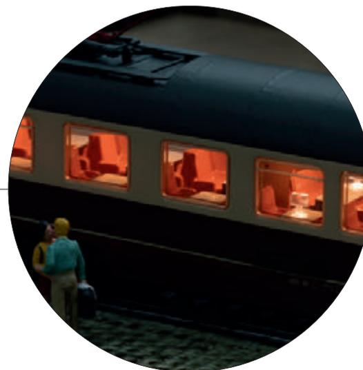
*Construction partiellement nouvelle de la voiture restaurant mixte ARmz 211.0 avec pantographes, réservoir tampon, son et lampes de table éclairées*
