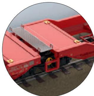
La tôle d'intercirculation rapportée est absolument conforme à l'original
