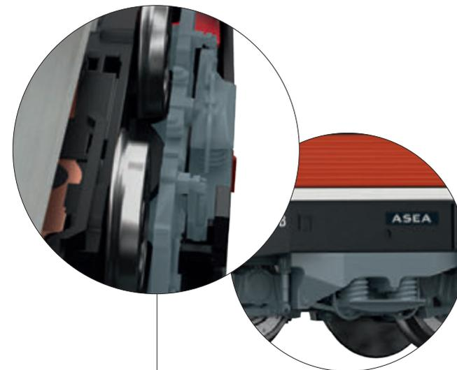
Afin de pouvoir représenter les ressorts et les stabilisateurs antiroulis dans leur tridimensionnalité, les suspensions des bogies sont réalisées d'une seule pièce de sorte à obtenir plus de profondeur pour le modèle.
