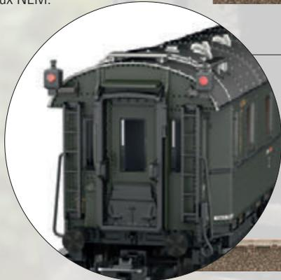
Équipé de série d'un éclairage de fin de convoi à l'une des extrémités
