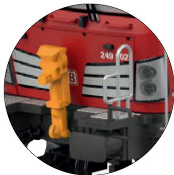
La Vectron avec plate-forme de manœuvre supplémentaire et imitation de l'attelage de manœuvre automatique
