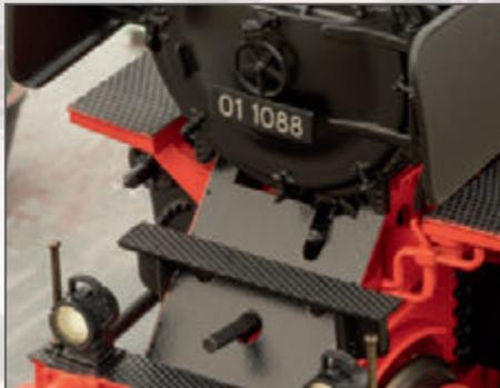
Une des caractéristiques de la remise en état dans l'atelier Henschel : la tôle de protection contre l'incendie ne va pas jusqu'à la chaudière.
