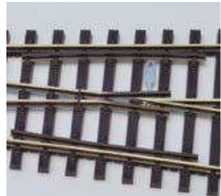
Kurz vor dem eigentlichen Herzstück erfolgt die elektrische Trennung der gegenseitig gepolten Flügelschienen.
