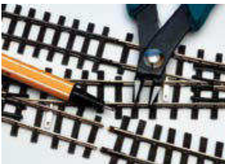
Werden H0e-Schmalspurweichen von Gerade auf Abzweig verbunden, sind Schwellen zu kürzen.
