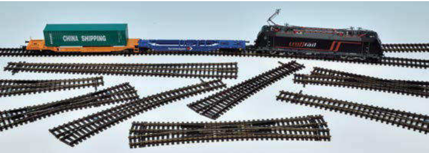
Eine Auswahl an unterschiedlichen H0 Weichentypen. Die private Mehrsystemlok (RailTop) und der Doppeltragwagen, ebenfalls ein Produkt aus dem Hause Tillig, sind auf der langen Weiche EW 6 platziert. Zwecks Einsicht fehlt die Containerbeladung auf der ersten Wagenhälfte.
