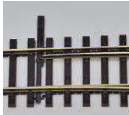
Nicht nur die normalen Schwellen, auch die Stellschwelle ist strukturiert. Zwei Positionen sind zur Stelldraht-Durchführung vorhanden.
